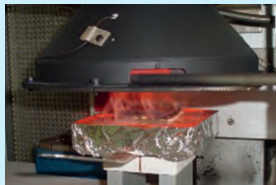
Dichas probetas son sometidas al efecto del calor en el horno
