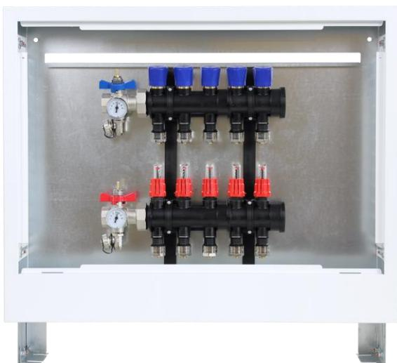
La caja metálica ALB para colectores está pensada para empotrar en la pared. La tapa regulable en profundidad permite dejar la caja alineada con la pared. Incorpora guías ajustables en el interior para ubicar las bridas de sujeción del colector. Los pies permiten regular también la altura a la que se instala la caja. Fabricadas en chapa metálica y con un acabado esmaltado en blanco.
