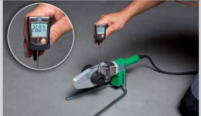
Control de la temperatura - dispositivo aquatherm (800 W)
