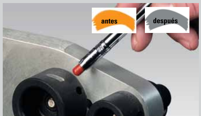
Control de temperatura con el lápiz indicador*
