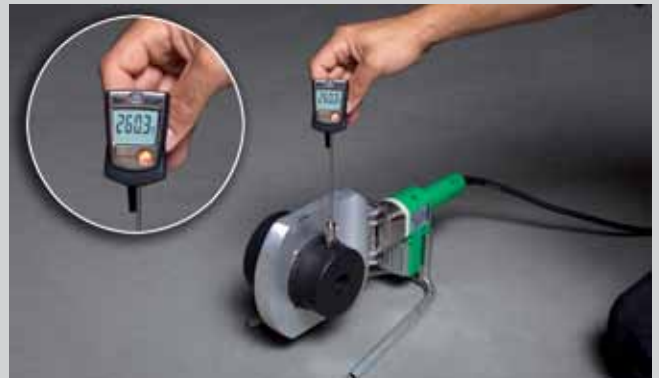
Control de la temperatura - dispositivo aquatherm (1400 W)
